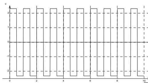
on obtient alors une fonction créneau de fréquence 1khz sur 10 périodes, d'amplitude 4 volts :
