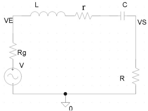
alimenter le circuit avec une tension sinusoïdale de fréquence fixe 1kHz d'amplitude environ 4 V,  $L=1\text{mH}$  et faire varier la capacité C de 200 pF à 0,5  $\mu\text{F}$  en relevant  $V_e$  et  $V_s$
