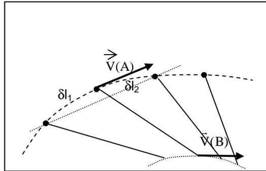
on reportera ensuite, avec une échelle convenable, les vecteurs vitesses, dans une zone voisine libre de la feuille on en déduit par construction la différence  $\vec{V}(A) - \vec{V}(B)$
