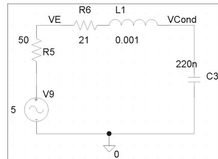
tracer à nouveau les courbes  $H(f)$  et  $\phi(f)$ , en déduire la valeur de la surtension aux bornes de C, la valeur de la pulsation de résonance en tension  $\omega_r$ , et déduire à partir de cette valeur,  $Q_0$  et  $\sigma$ ;
